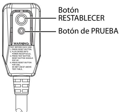
El cortacircuitos tiene que estar probado regularmente presionando el botón de prueba (**TEST**) y el botón de restablecimiento (**RESET**). Si el botón de prueba (**TEST**) no hace tropezar el cortacircuitos o si el botón de restablecimiento (**RESET**) no se queda engranado, desenchufe inmediatamente el aire acondicionado y contacte un técnico de Insignia.
