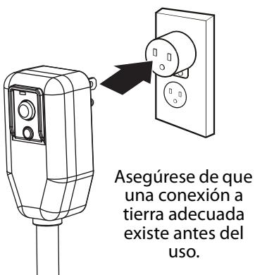
Para evitar de dañar la clavija del adaptador de puesta a tierra, mantenga el adaptador mientras enchufe o desenchufe el aire acondicionado.
