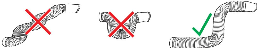
**Cuidado:** La manguera de escape está diseñada especialmente para este aire acondicionado. El reemplazo o el alargamiento de la manguera puede resultar en daños a la unidad.
