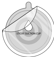
2. Retirez le film protecteur de la ventouse puis appuyez-la fermement sur le pare-brise.
