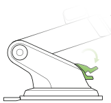
3. Presione la palanca de bloqueo hacia abajo para asegurar el soporte.
