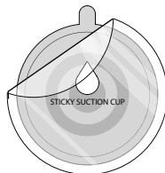
2. Quite el papel protector de la ventosa y presione firmemente el soporte sobre la almohadilla del parabrisas.
