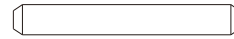
(F) Metal Pin/ Pin en métal/ Aguja de metal X 4( Ø4 X 30)
