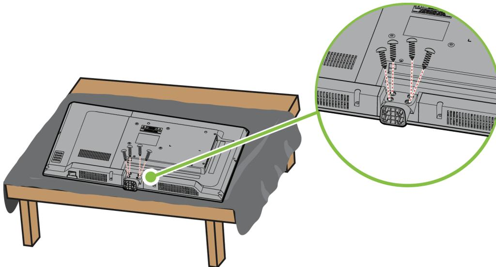
3 Fije la columna del televisor a la columna base con cuatro de los tornillos M4 suministrados.
