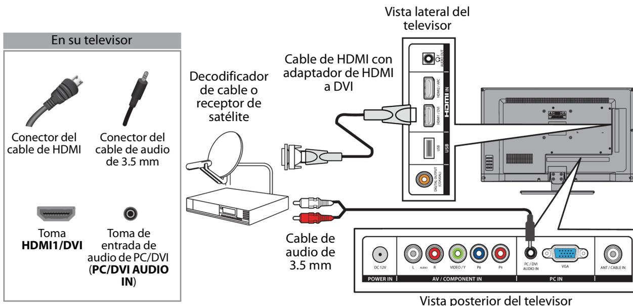
**Para conectar un decodificador de cable o receptor de satélite usando DVI:**
