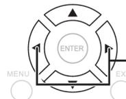
Presione el botón direccional derecho o izquierdo para mover el cursor en la pantalla o para ajustar un elemento seleccionado.
