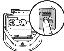
L'ampoule de la lampe clignotera et la DEL sur la commande intelligente s'éteindra une fois que le dispositif aura été programmé.
