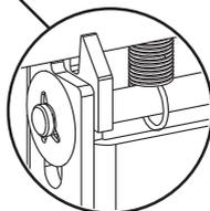
Le système de verrouillage automatique à ressort s'enclenche sur la plaque murale lorsque les supports sont appuyés après la fixation du téléviseur. Ceci empêche que le téléviseur ne se détache.
