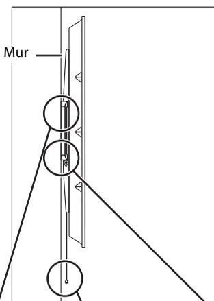
Les supports doivent s'enclencher dans les encoches de la plaque murale afin de fixer le téléviseur en place.
