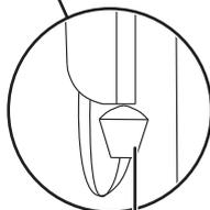
Les cordons ont une boule magnétique à l'extrémité afin de les fixer aux supports pour les garder hors de vue.
