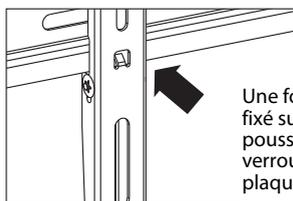
Une fois que le téléviseur est fixé sur la plaque murale, pousser les supports afin de verrouiller l'assemblage à la plaque murale.
