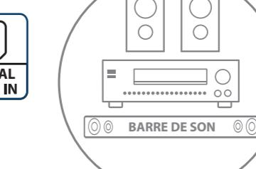
Il est possible d'utiliser la prise de SORTIE OPTIQUE NUMÉRIQUE ou la prise HDMI 1 (eARC ou ARC).
