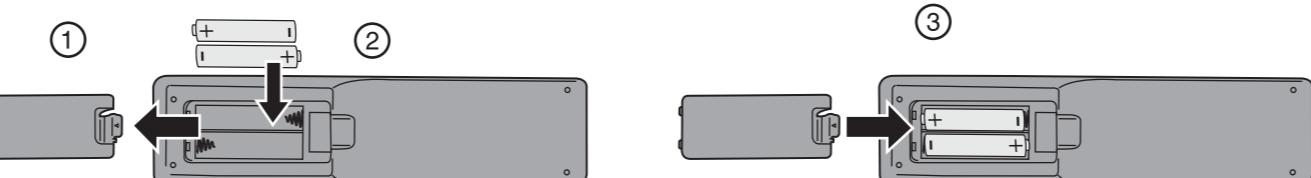
2 Inserte dos pilas AAA en el compartimiento de pilas. Verifique que los símbolos + y – en las pilas correspondan con los símbolos + y – en el compartimiento de las pilas.
