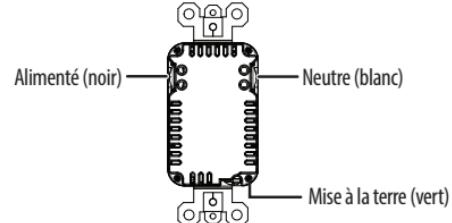
Insérer le fil étiré dans l'un des deux orifices des emplacements alimenté et neutre sur le côté de la prise secteur. L'alimentation passe entre les deux orifices correspondants pour le câblage interconnecté. Fixer le fil de mise à la terre dans la partie inférieure de la prise.
