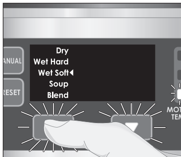
2. 按下过程选择按钮，直到箭头到达所需的操作。每个操作都有设定的混合时间。
