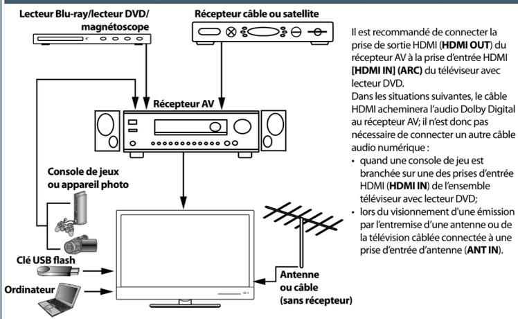
Il est recommandé de connecter la prise de sortie HDMI (HDMI OUT) du récepteur AV à la prise d'entrée HDMI (HDMI IN) (ARC) du téléviseur avec lecteur DVD. Dans les situations suivantes, le câble HDMI acheminera l'audio Dolby Digital au récepteur AV; il n'est donc pas nécessaire de connecter un autre câble audio numérique :
