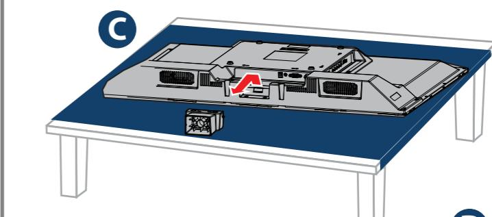
Le téléviseur a quatre trous de montage VESA au dos. Si un support de montage mural est fixé au dos du téléviseur, le support doit être fermement fixé en utilisant les quatre trous. Si les quatre trous de montage ne sont pas tous utilisés, cela pourrait provoquer la chute du téléviseur et être source de dommages matériels et de blessures graves. Voir la documentation livrée avec le support de montage mural pour toutes instructions de montage.
