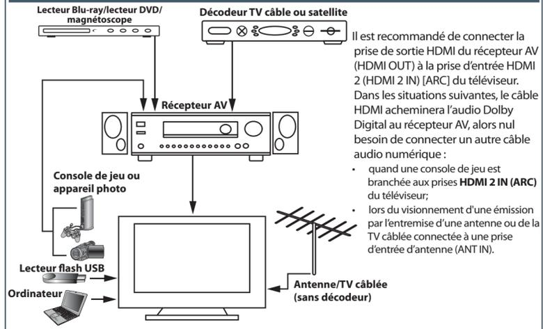
Il est recommandé de connecter la prise de sortie HDMI du récepteur AV (HDMI OUT) à la prise d'entrée HDMI 2 (HDMI 2 IN) [ARC] du téléviseur. Dans les situations suivantes, le câble HDMI acheminera l'audio Dolby Digital au récepteur AV, alors nul besoin de connecter un autre câble audio numérique :
