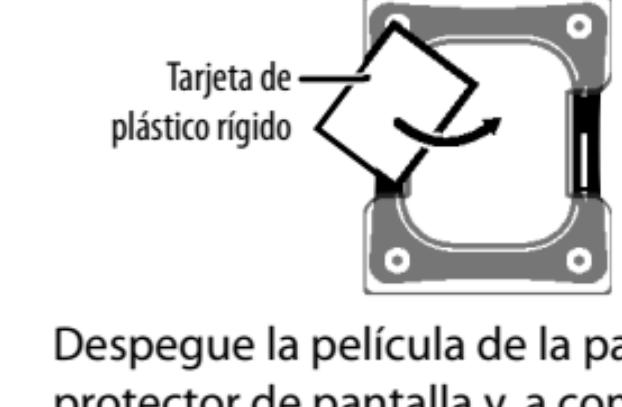
**7** Utilice la tarjeta de plástico rígida para presionar el protector de pantalla contra la esfera de su reloj de un borde a otro.
