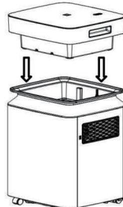
Remarque: Lorsque le réservoir d'eau est plein, veuillez vider l'eau. Avant de remettre le réservoir d'eau en place, vérifiez que le flotteur fonctionne, puis utilisez les deux mains pour remettre le réservoir d'eau en place.
