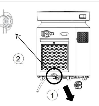
Remarque: le tuyau d'évacuation externe ne doit pas être trop long (la longueur recommandée est inférieure à 0,6 m/2 ft). La hauteur de l'extrémité du tuyau doit être inférieure d'au moins 10 cm/4" à la sortie d'évacuation de la machine.
