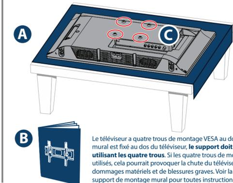
Le téléviseur a quatre trous de montage VESA au dos. Si un support de montage mural est fixé au dos du téléviseur, **le support doit être fermement fixé en utilisant les quatre trous**. Si les quatre trous de montage ne sont pas tous utilisés, cela pourrait provoquer la chute du téléviseur et être source de dommages matériels et de blessures graves. Voir la documentation livrée avec le support de montage mural pour toutes instructions de montage.
