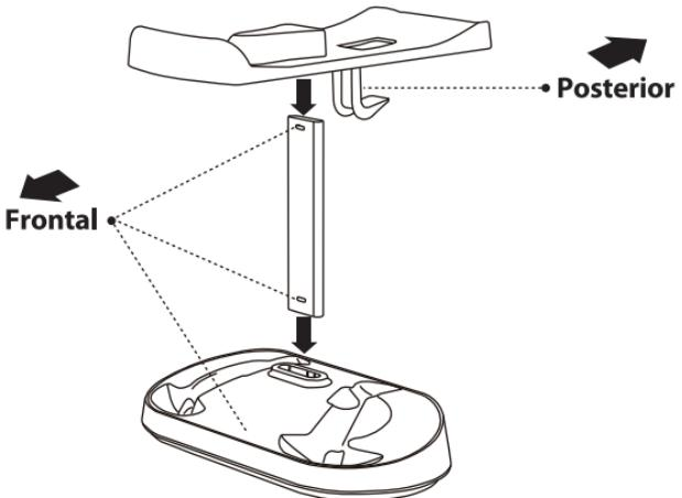
2. Presione la parte superior de la base para asegurarse de que está bien sujetada.
