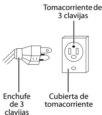
Uso de un adaptador de conexión a tierra
