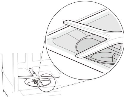
Tras extraer la bandeja inferior, coloque un nivel en la pared interior de la cuba para verificar que el lavavajillas esté nivelado de lado a lado.
