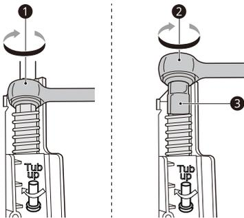
Ajuste las patas de nivelación delanteras y traseras hasta que hagan contacto firme con el piso. Si el lavavajillas no está bien nivelado puede impedir que la puerta cierre correctamente y el artefacto no se encenderá.
