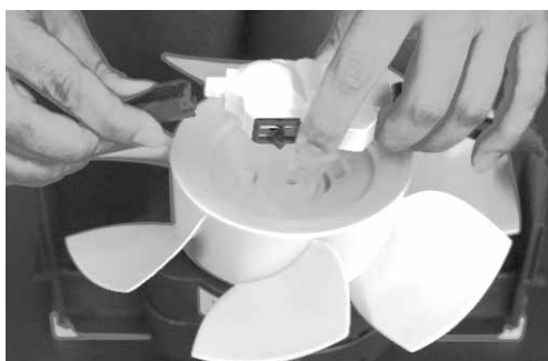
Fig 6. ... tire suavemente, 1/8 pulgadas, de uno de los brazos de la unidad motriz...
