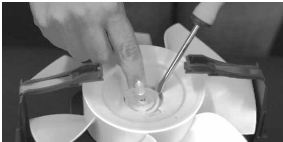
Fig 7. Retirez la bague de verrouillage ... en faisant levier à l'aide d'un petit tournevis ...
