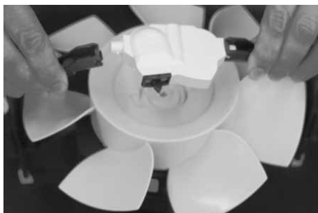
B.... colóquelo entre los brazos de la carcasa del motor...
