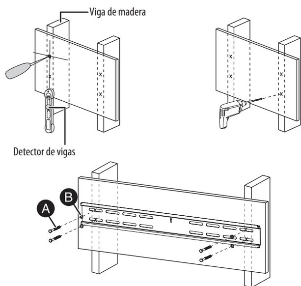
\* Tamaño mínimo de la viga de madera: estándar 2 x 4 pulg. (51 x 102 mm) nominal 1 1/2 x 3 1/2 pulg. (38 x 89 mm).
