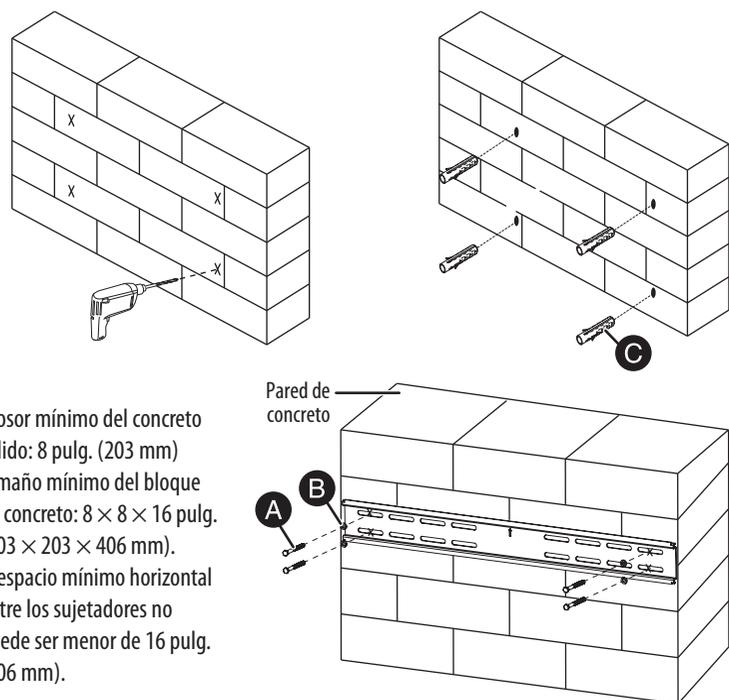
\* Grosor mínimo del concreto sólido: 8 pulg. (203 mm)
