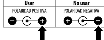
**4** Pruebe una punta introduciéndola suavemente en la toma de CC de su dispositivo. Debería quedar bien sujetada sin tener que introducirla a la fuerza en la toma de CC. Si tienes su adaptador viejo, puedes comparar el conector con las puntas suministradas.
