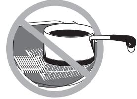
No deslice los utensilios de cocina por el control o la superficie de la placa de cocción porque puede rayar el vidrio. El cristal es resistente a los rayones, no a prueba de ellos.
