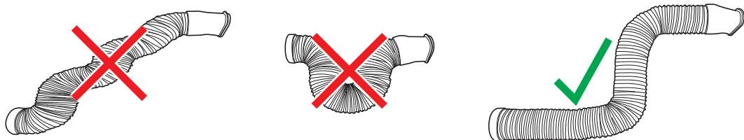
**Attention :** Le conduit d'évacuation est conçu spécifiquement pour ce climatiseur. Le remplacement ou le rallongement de ce conduit pourrait endommager cet appareil.
