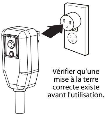
Pour éviter d'endommager le terminal de mise à la terre de l'adaptateur, tenir ce dernier en place lorsque le climatiseur est branché ou débranché.
