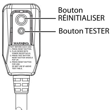
Le disjoncteur doit être testé régulièrement en appuyant sur le bouton **TEST** (Tester), puis sur le bouton **RESET** (Réinitialiser). Si le bouton **TEST** ne déclenche pas le disjoncteur, ou si le bouton **RESET** ne reste pas enfoncé, débrancher le climatiseur immédiatement et contacter un technicien d'Insignia.
