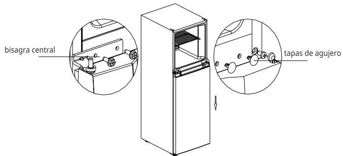
7 Instale la puerta del congelador en la bisagra central, e instale la bisagra superior, la cubierta de la bisagra y la tapa del agujero.
