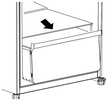
3 Para reemplazar el cajón, deslícelo en el compartimento y luego bájelo a su posición.
