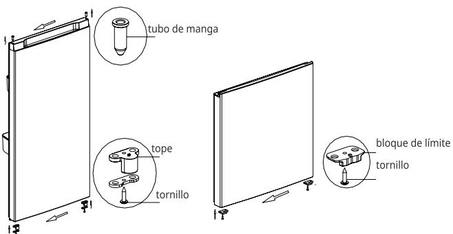
6 Instale la puerta del compartimento del refrigerador en la bisagra inferior y luego instale la bisagra central y las tapas de agujero.
