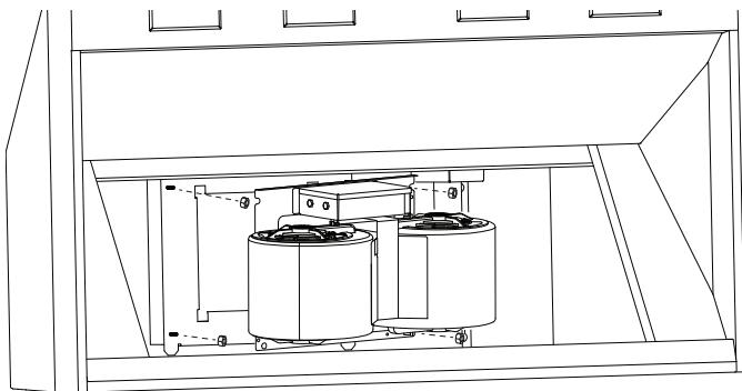
2. Fixez les quatre écrous (fournis avec la hotte) aux goujons soudés. Serrez les écrous pour fixer le ventilateur à la hotte.
