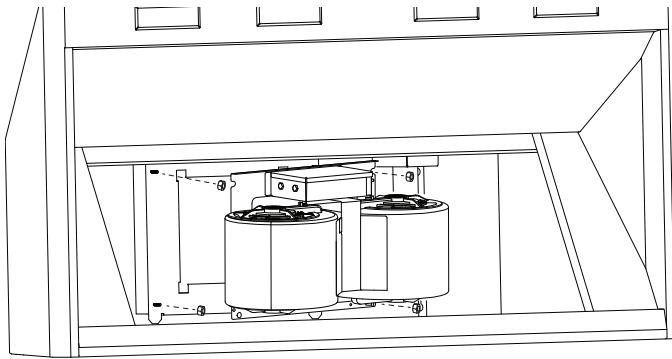
2. Fije las cuatro tuercas (proporcionadas con la campana) a las clavijas soldadas. Apriete las tuercas para fijar el ventilador a la campana.
