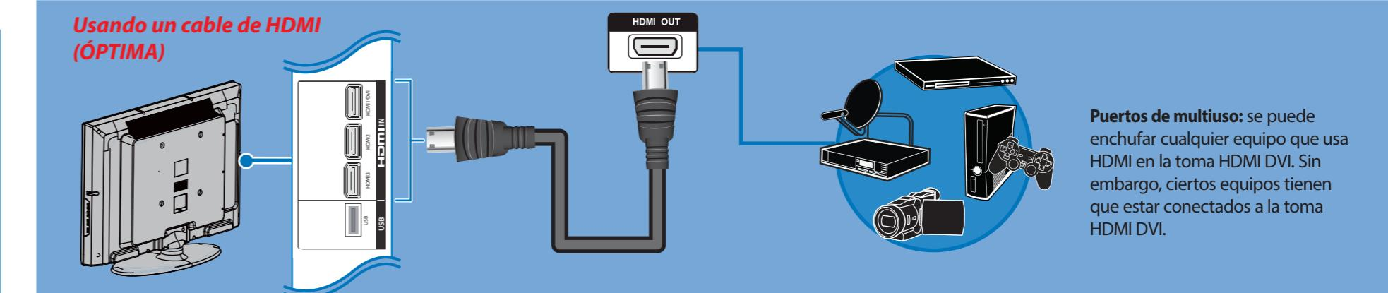
Puertos de multiuso: se puede enchufar cualquier equipo que usa HDMI en la toma HDMI DVI. Sin embargo, ciertos equipos tienen que estar conectados a la toma HDMI DVI.
