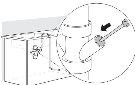
**2** Sujete la manguera de desagüe a la pieza en T para desechos con la abrazadera para manguera suministrada. Mueva la abrazadera a la posición correcta y apriétela con un destornillador de hoja plana.
