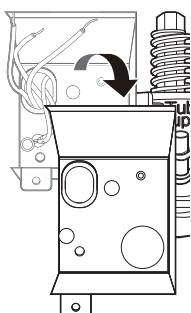
**5** Inserte el aliviador de tensión **2** a través del orificio de la caja de empalmes. Apriete la tuerca redonda **3** para asegurarla en su sitio.
