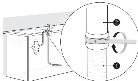
**3** Si no está conectado, acople el conector de la manguera de caucho a la pieza en T para desechos o al triturador con una abrazadera para manguera (no incluida).
