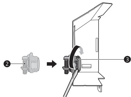
**6** Inserte el cable eléctrico a través del orificio del aliviador de tensión. Ajuste los 2 tornillos para asegurarlo.
