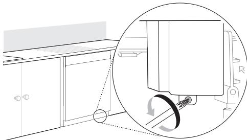
**3** Utilice un destornillador Phillips para retirar 2 tornillos **1**.
