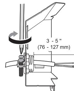
**7** Tire de los cables existentes a través de las aberturas de la caja de empalmes. Ajuste los 2 tornillos **4** para volver a ensamblar la caja de empalmes en el artefacto.
