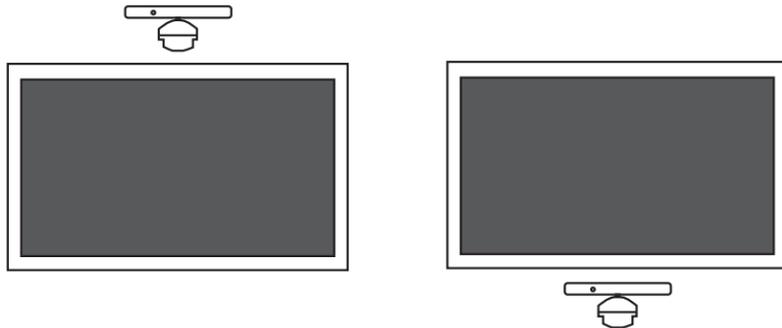
**1** Trouver un endroit sur le mur (au-dessus ou en dessous du téléviseur) pour fixer le support mural. Il est possible de fixer le support sur un montant mural ou d'utiliser les dispositifs d'ancrage inclus.
