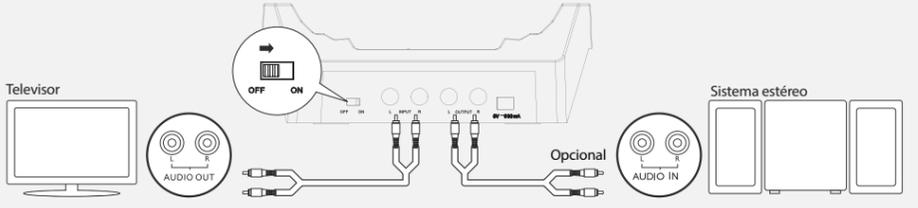
**Nota:** si su dispositivo de audio no tiene salidas RCA, usted puede usar un adaptador 3.5 mm a RCA (incluido) para hacer las conexiones. Su conexión podría ser distinta al ejemplo mostrado.
