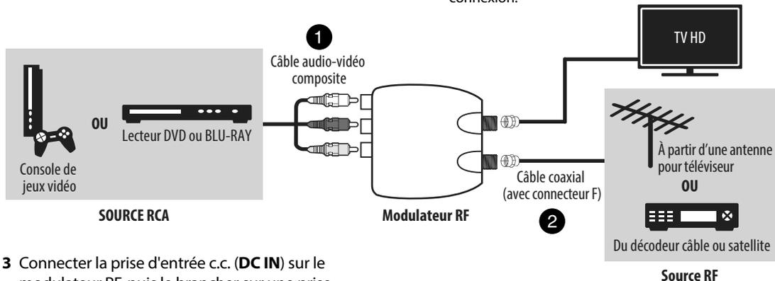
**3** Connecter la prise d'entrée c.c. (**DC IN**) sur le modulateur RF, puis le brancher sur une prise secteur 120 V c.a. normale.
