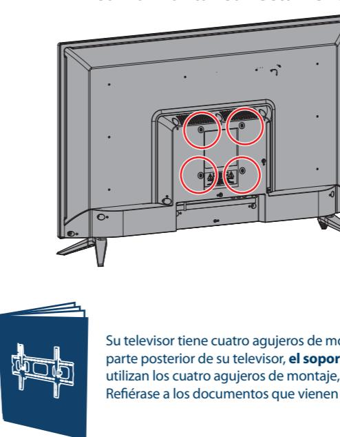
Su televisor tiene cuatro agujeros de montaje VESA en la parte posterior. Si fija un soporte de montaje en pared a la parte posterior de su televisor, **el soporte se debe sujetar firmemente, utilizando los cuatro agujeros**. Si no se utilizan los cuatro agujeros de montaje, el televisor podría caerse y causar daños a la propiedad o lesiones personales. Refiérase a los documentos que vienen con su montaje en pared para las instrucciones completas de montaje.
