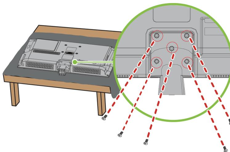
**3** Retirer l'axe du socle.
