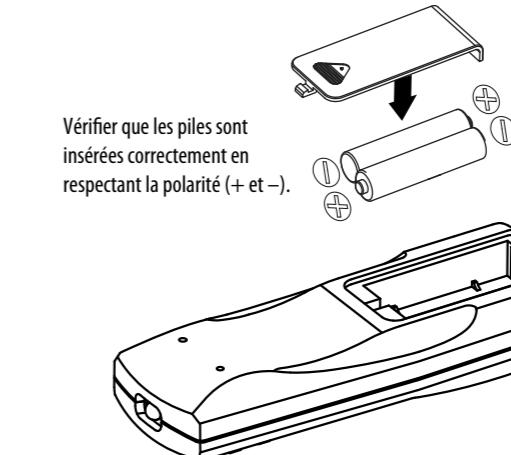
Vérifier que les piles sont insérées correctement en respectant la polarité (+ et -).
