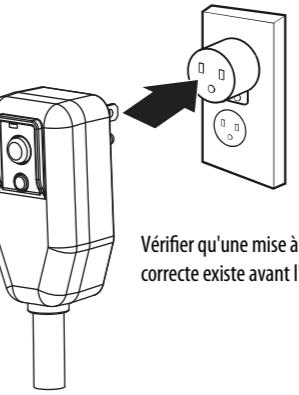
Pour éviter d'endommager le terminal de mise à la terre de l'adaptateur, tenir ce dernier en place lorsque le climatiseur est branché ou débranché.
