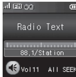
Le mode RDS (Radio Broadcast Data System - RBDS) ajoute une fonctionnalité supplémentaire à la réception radio FM en transmettant une information analogique codée avec le signal radio FM. Ce signal est décodé par un récepteur RDS et peut fournir toute une gamme d'informations y compris le nom de la station. Le texte RDS est en général centré. Quand le texte remplit l'affichage, il commence à défilez. Lors de la réception d'un signal RDS, l'icône « RDS » (RBDS) s'affiche.
