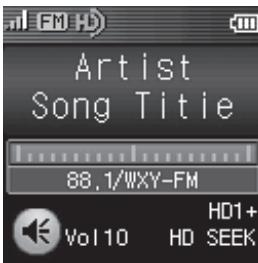
Le mode HD Radio est le nouveau signal numérique. Plusieurs stations HD Radio ont plusieurs sous-canaux appelés « Canaux multiplexés » (Multicast channels). Lors de la réception d'un signal HD Radio, l'icône « HD » et le numéro de canal s'affichent.
