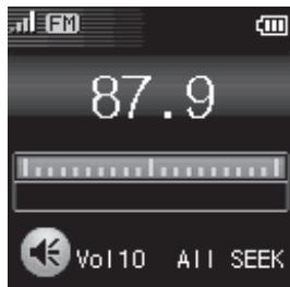
Le mode analogique (FM) est le mode standard. Le signal radio FM est un signal analogique. Lors de la réception d'un signal FM, l'icône « FM » s'affiche.
