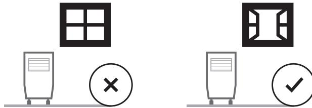
**IMPORTANTE:** Le refroidisseur d'air par évaporation n'est pas un climatiseur, car il ne fonctionne pas au moyen d'un compresseur ni de gaz frigorigène. Il ne faut pas s'attendre à ce qu'il rafraîchisse autant qu'un climatiseur réfrigérant.
