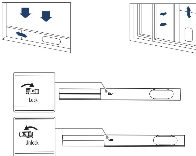
**4** Insérer l'adaptateur du tuyau dans le panneau d'aération, puis le faire glisser jusqu'à ce qu'il s'enclenche dans son emplacement.
