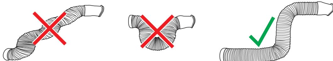
**Attention :** Le conduit d'évacuation est conçu spécifiquement pour ce climatiseur. Le remplacement ou le rallongement de ce conduit pourrait endommager cet appareil.
