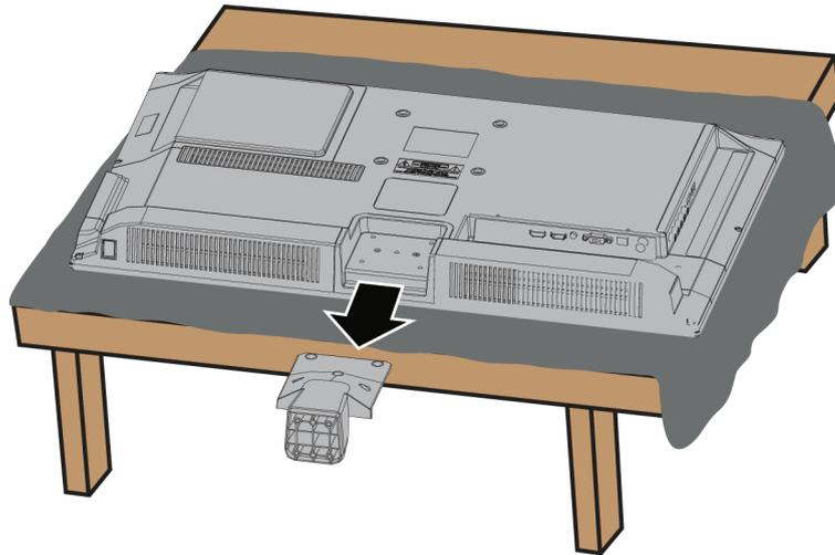
4 Fije el soporte de montaje en pared a su televisor usando los agujeros de montaje en la parte posterior de su televisor. Vea las instrucciones que vienen con el soporte de montaje en pared para la información de cómo colgar correctamente su televisor.
