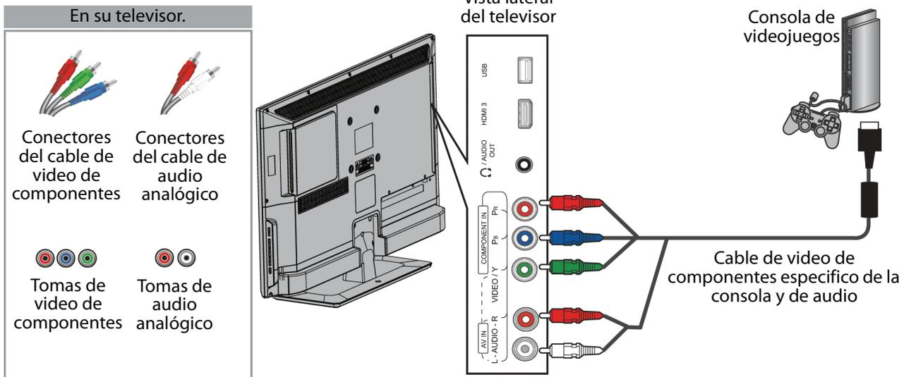
**Para Conectar una consola de videojuegos usando el video de componentes:**
