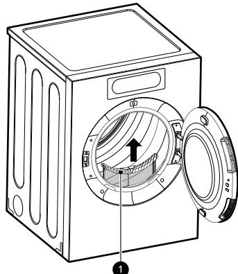
Asegúrese siempre de que el filtro de pelusa esté instalado correctamente antes de poner en funcionamiento la secadora. Hacer funcionar la secadora sin el filtro o con el filtro de pelusa suelto podría dañar la secadora y los artículos que se encuentran en su interior.
