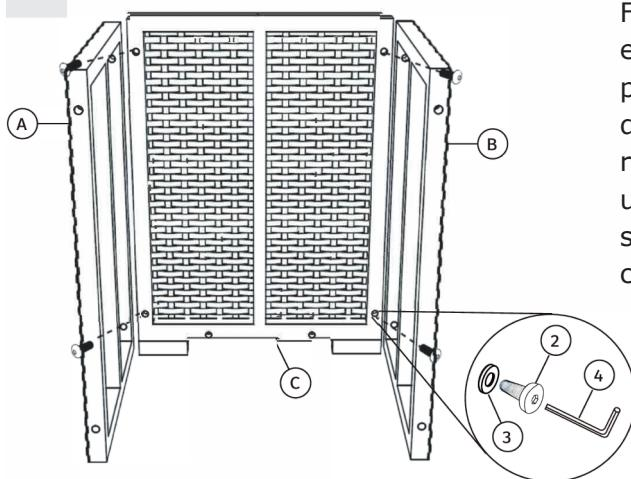
Fixez le panneau (A) et le panneau (B) au panneau (C) à l'aide de 4 boulons (2) et 4 rondelles M6 (3) avec une clé Allen (4). Ne serrez pas complètement.
