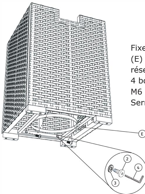
Fixez le support métallique (E) au bas du couvercle du réservoir d'essence à l'aide de 4 boulons (2) et 4 rondelles M6 (3) avec clé Allen (4). Serrez complètement.
