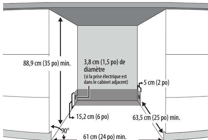
Si le refroidisseur est installé entre des armoires sans armature, une bande de remplissage ou un panneau latéral de 1,3 cm (0,5 po) de large peut être nécessaire des deux côtés du refroidisseur. La bande de remplissage crée un espace entre le boîtier de l'appareil et le battant de la porte de l'armoire adjacente. La largeur de l'ouverture doit inclure les panneaux de remplissage. La porte doit se déployer au moins à 2,6 cm (1 po) au-delà des armoires environnantes.
