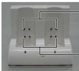
Contacts de charge pour les blocs-batteries quand ces derniers sont installés dans la télécommande Wii
