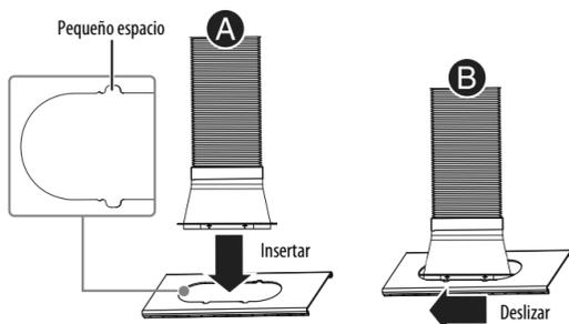
**Opcional:** Fije la manguera de ventilación al adaptador de ventilación con los tornillos suministrados. Refiérase a su *Guía del usuario* para obtener información adicional.
