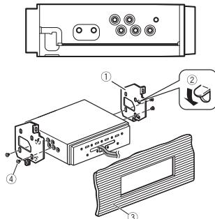
① Soporte de montaje de radio de fábrica
