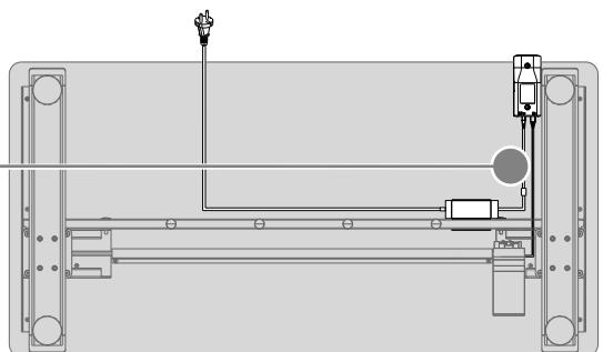
3 Brancher le petit connecteur du câble d'alimentation sur le connecteur femelle de l'adaptateur (voir les détails).
