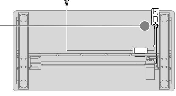
5 Fixer les câbles sur la partie inférieure du pupitre à l'aide des attaches de câbles fournies (voir les détails).
