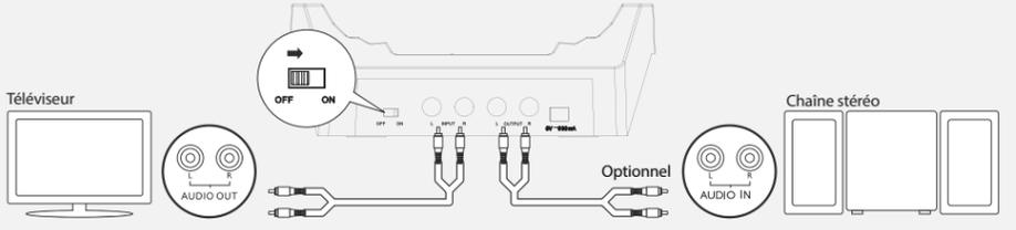
**Remarque :** Si le périphérique audio n'a pas de sorties RCA, il est possible d'utiliser l'adaptateur de 3,5 mm à RCA (inclus) pour effectuer les connexions. La configuration de l'utilisateur peut être différente de l'exemple illustré ci-dessus.
