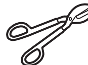
Tijeras de hojalatero (Para cortar la válvula anti-retorno, si es necesario)
