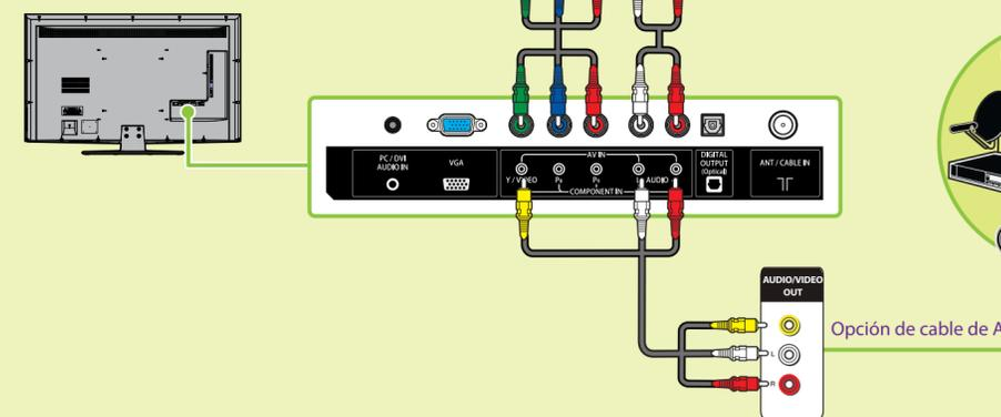
**Nota:** las tomas de video de componentes y de AV están compartidas. Esto significa que se puede conectar solo un equipo de video de componentes o de AV a la vez. Le sugerimos usar HDMI si su equipo lo admite.
