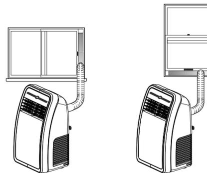
**Nota:** Para un desempeño óptimo, no retuerza la manguera de ventilación y asegúrese de que no tenga curvas. Para una eficacia óptima, acorte la manguera, presionando las secciones.
