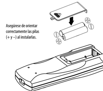
Asegúrese de orientar correctamente las pilas (+ y -) al instalarlas.
