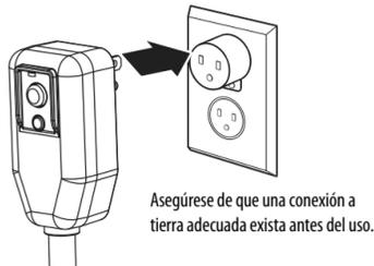
Para evitar de dañar la clavija del adaptador de puesta a tierra, mantenga el adaptador mientras enchufe o desenchufe el aire acondicionado.
