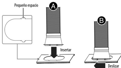
**Opcional:** Fije la manguera de ventilación al adaptador de ventilación con los tornillos suministrados. Refiérase a su *Guía del usuario* para obtener información adicional.
