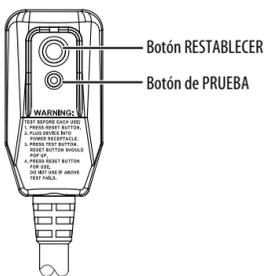
El cortacircuitos tiene que estar probado regularmente presionando el botón de prueba (**TEST**) y el botón de restablecimiento (**RESET**). Si el botón de prueba (**TEST**) no hace que se dispare el cortacircuitos o si el botón de restablecimiento (**RESET**) no se queda activado, desenchufe inmediatamente el aire acondicionado y contacte un técnico de Insignia.
