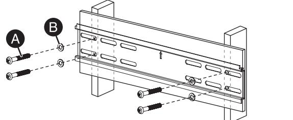
\* Tamaño mínimo de la viga de madera: estándar 2 x 4 pulg. (51 x 102 mm) nominal 1 1/2 x 3 1/2 pulg. (38 x 89 mm).
